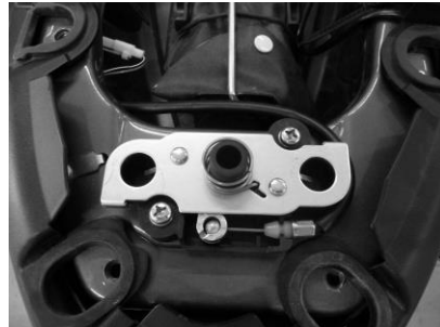
2° Position du système de verrouillage de selle
